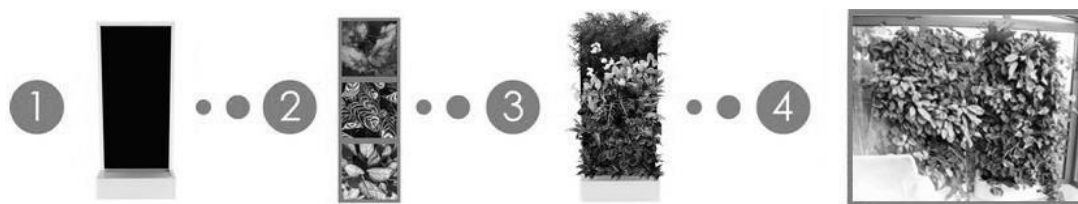
Ryc. 1 Schemat powstawania minimalistycznej zielonej ściany (M. Gajdemska).
